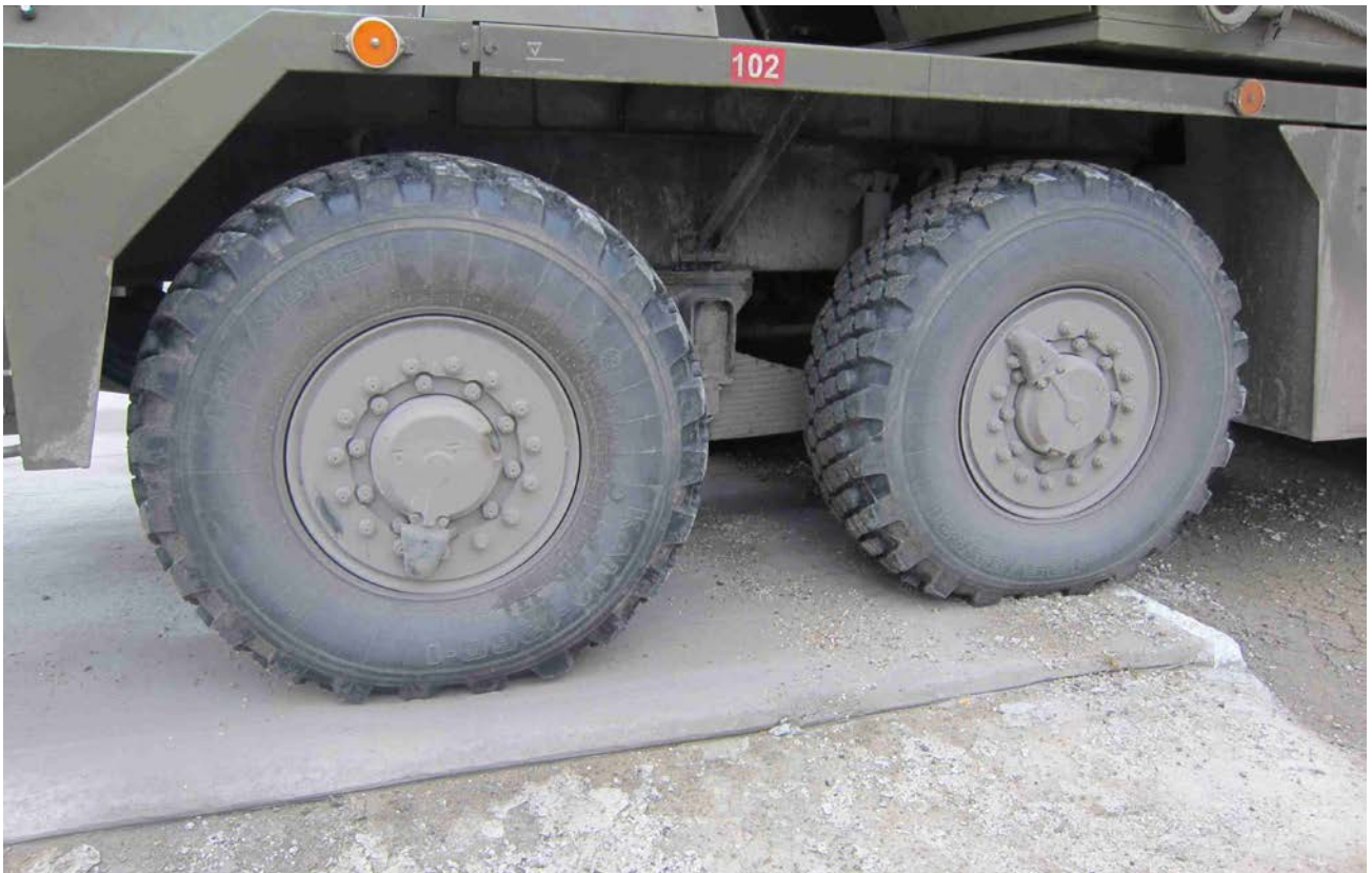
Fot. 1. Próba zastosowania pianobetonu w Trencinie, Słowacja [13]
